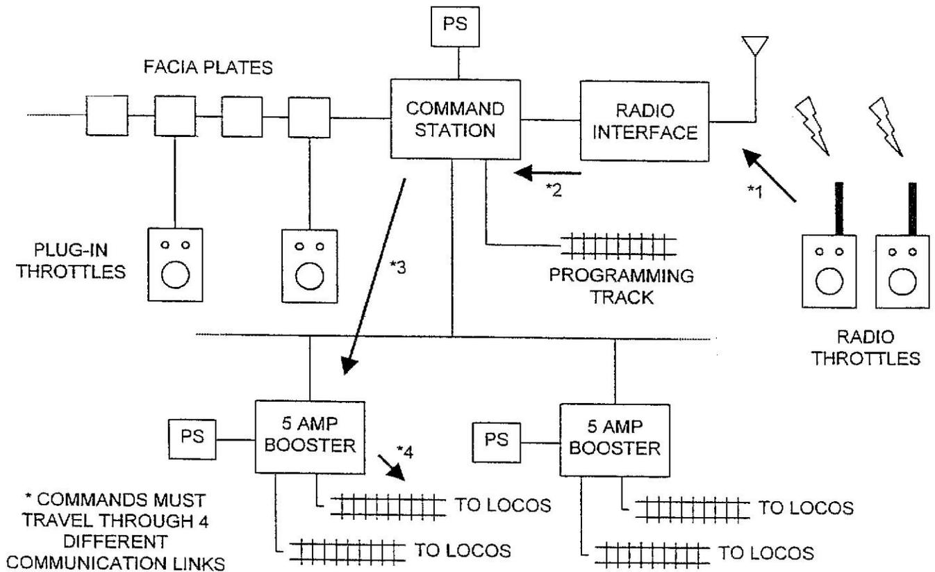
**TYPICAL DCC WIRELESS SYSTEM BLOCK DIAGM**
